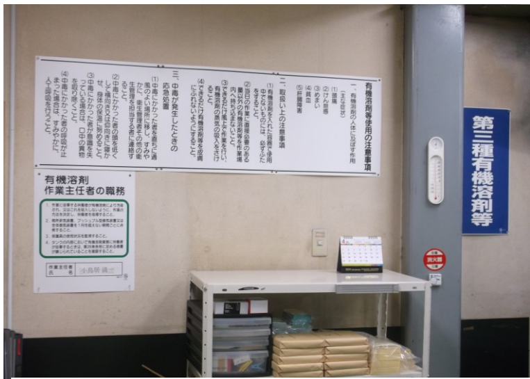
法律に基づいた表示をしている例(弥生印刷紙工場内)
